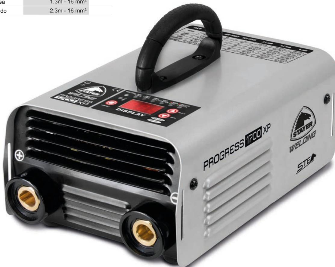
Equipo inverter superior de 170 amperios, dimensiones muy reducidas con un 100% de factor de marcha y configurable para obtener resultados óptimos en soldadura con electrodo recubierto y TIG Lift Arc sin contacto.
